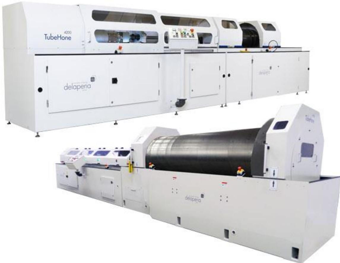
Levigatrici per interni cilindrici fino a 4 metri di lunghezza. Diametro standard fino a 650mm, su richiesta fino a 1m
