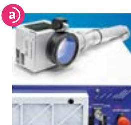
Per questa tipologia di applicazione è sempre richiesto un laser a Fibra FP. Non vi è alcuna necessità di utilizzare un laser Fibra VP (MOPA). Considerando le caratteristiche intrinseche dell'alluminio (più refrattario alla marcatura laser rispetto, ad esempio, all'acciaio) è opportuno utilizzare delle focali corte o comunque non troppo lunghe.
