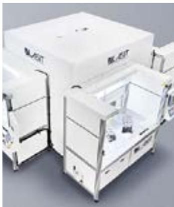
Macchina realizzata per Ferrari – dove ne abbiamo 17 – per la marcatura del 12 cilindri. Ha tre canali di alimentazione ed è equipaggiata con robot ABB, sistema di scansione 3D, laser da 50W, autofocus, sistema di visione e sistema di sorveglianza integrato.
