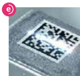
Quando la marcatura viene effettuata sul grezzo, è solitamente richiesto un primo passaggio di pulizia dell'area su cui si marcherà il DMC per rendere la superficie più adatta alla marcatura e soprattutto migliorare il contrasto e dunque la qualità stessa. Solitamente per questa tipologia di lavorazioni viene utilizzato un laser da 50W.
