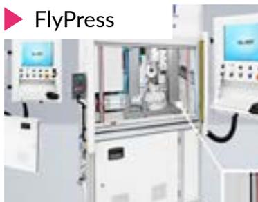
Macchina realizzata in più varianti per Le Belier. La caratteristica principale di questa macchina è la combinazione tra laser, visione e soprattutto sistema di prova tenuta ad aria e verifica ottica di una filettatura.
