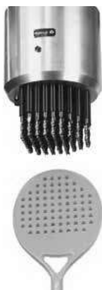
Aplicación de taladrado simultáneo de 76 orificios en paleta de paddle.
