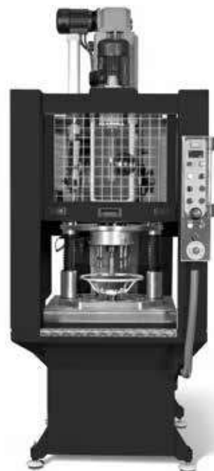
Unidad de taladrado con cabezal múltiple de volantes de conducción para sector de automoción, bajo rigurosas normas técnicas y de seguridad del cliente.
